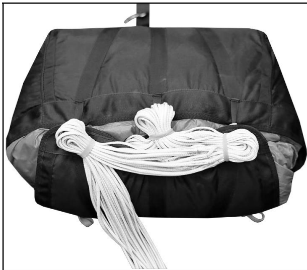
Рисунок 111 – Зачековка стропами камеры ОП
