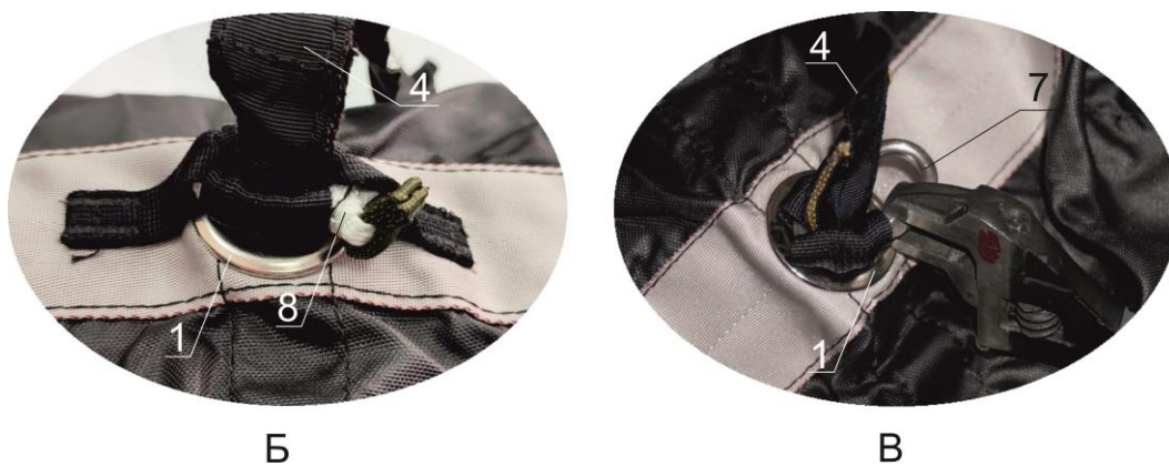
Рисунок 15 – Камера ОП и вытяжное звено с «коллапсом»
