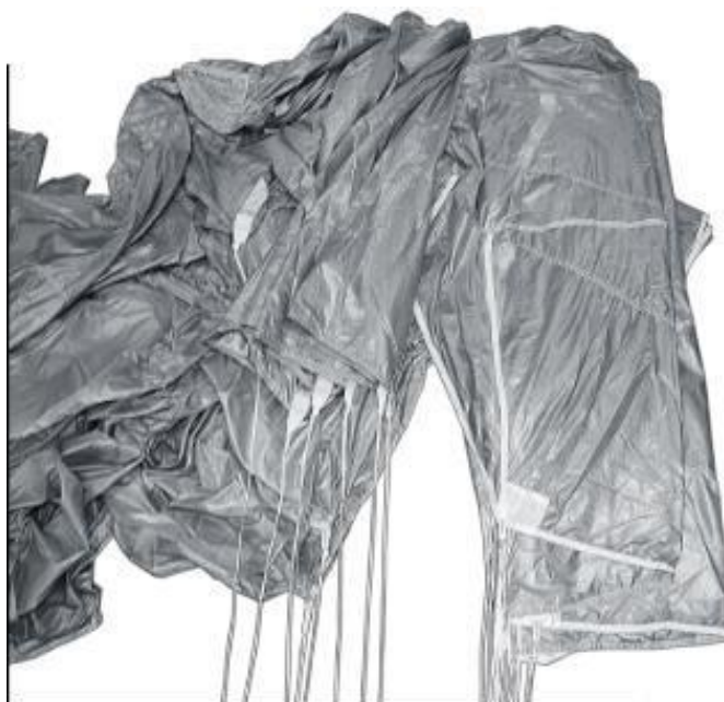
Рисунок 48 – Укладка полотнищ между стропами 3 и 4 ряда
