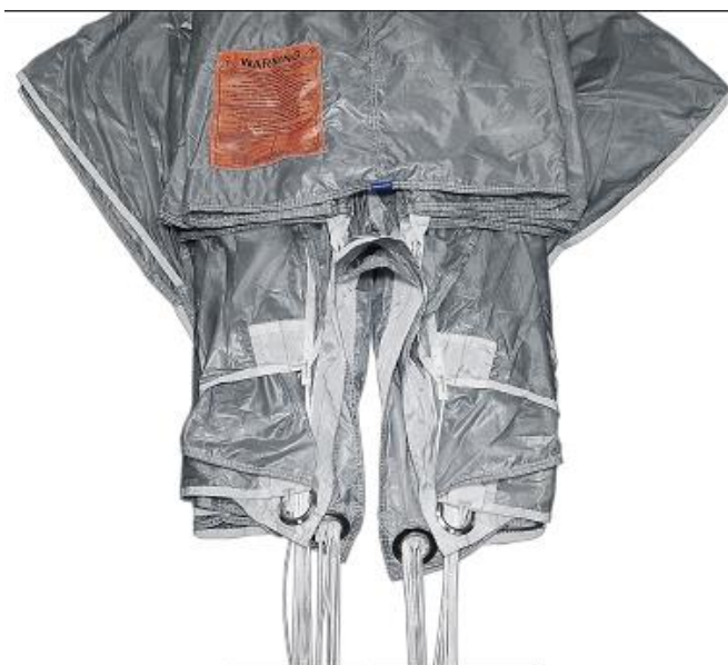
Рисунок 55 – Размещение слайдера между уложенными полотнищами
