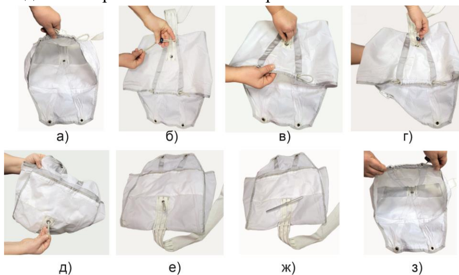
Рисунок 41 – Подготовка камеры ЗП к укладке
