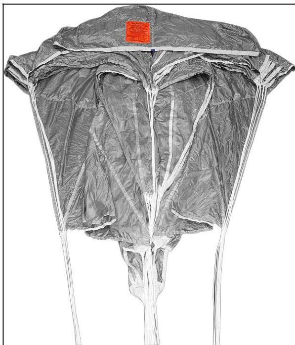
Рисунок 103 – Укладка задней кромки купола
