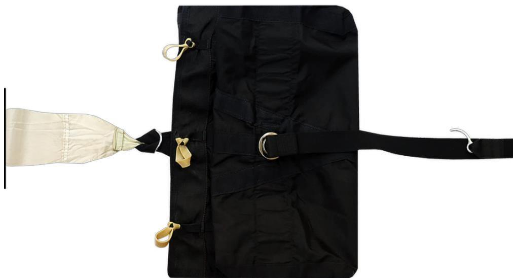
Рисунок 90 – Монтаж вытяжного звена ОП
