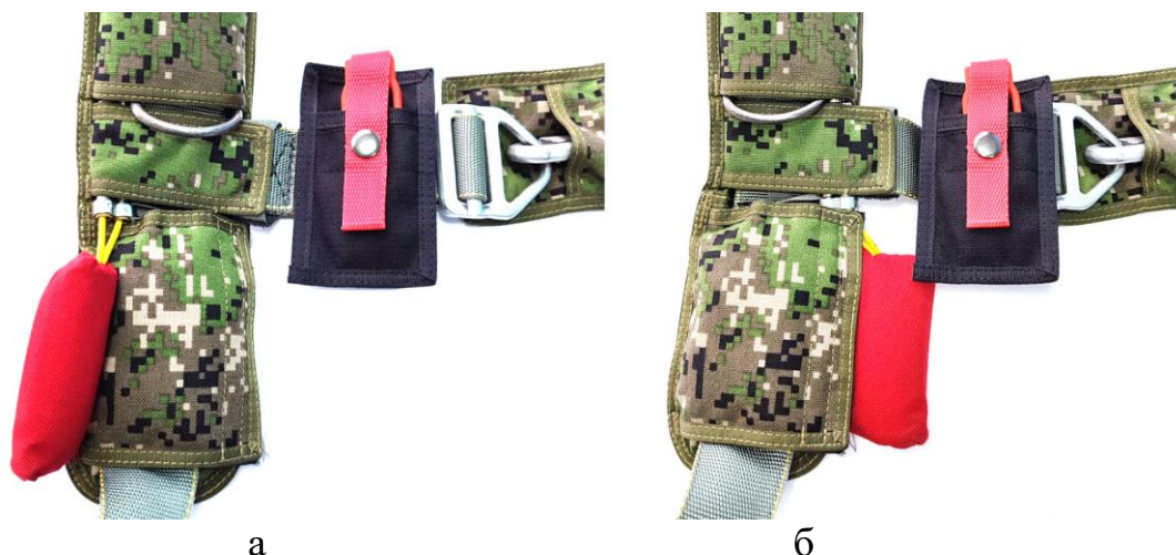
Рисунок 93 – Монтаж звена отсоединения СК
