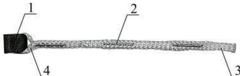
Рисунок 14 – Звено соединительное «софтлинк» 1 – фиксатор; 2 – шнур звена; 3 – петля; 4 – петля под фиксатором
