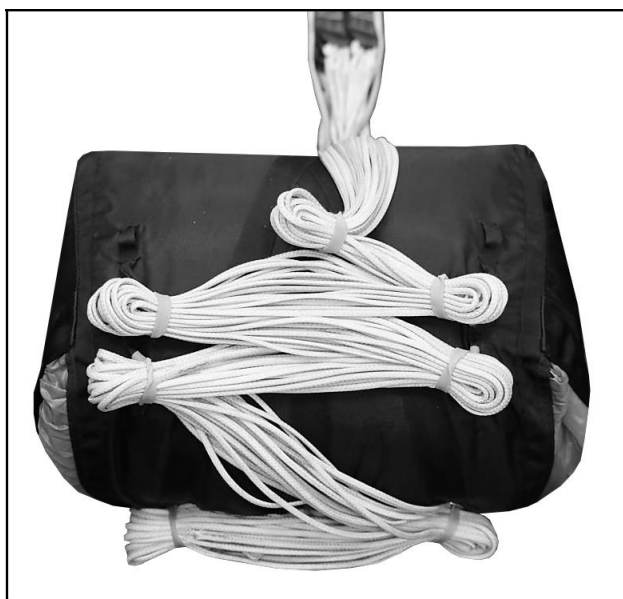
Рисунок 112 – Укладка строп (вид с обратной стороны камеры)
