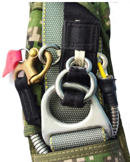
Рисунок 96 – Монтаж пряжки звена «Транзит»
