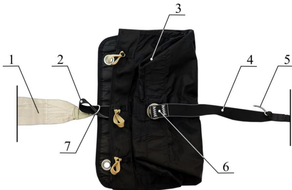
Рисунок 88 – Монтаж вытяжного звена ОП
