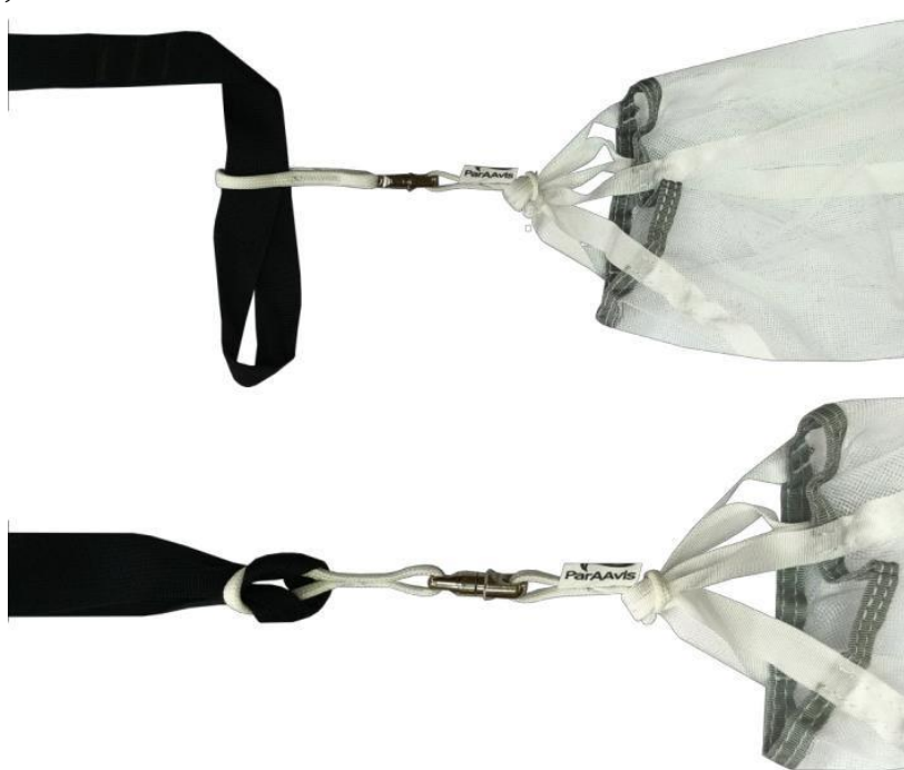
Рисунок 92 – Монтаж МВП на вытяжное звено (узел-удавка условно не затянут)
